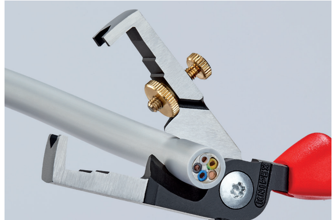
Induktiv gehärtete Scherschneide mit Präzisionsschliff zum quetschfreien Schneiden von Kupferkabeln bis Ø 15 mm (5 x 2,5 mm 2 )
