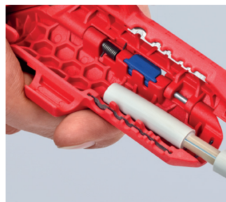
Abmanteln eines NYM-Kabels
