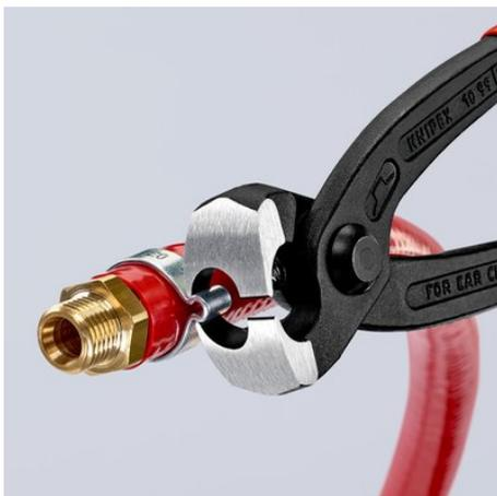
Abdichten Fluidschlauch an Stutzen mittels Seiten-Pressnase
